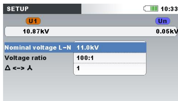
figura 4.17: Rapporto di tensione ad esempio trasformatore 11 kV / 110 kV
