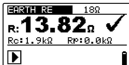
figura 0.9: Esempio del risultato di una misura di Terra
