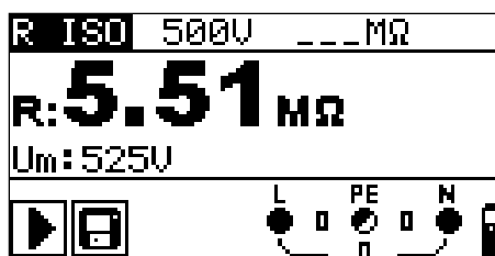
figura.5.7: Esempio risultato della misurazione di resistenza di isolamento
