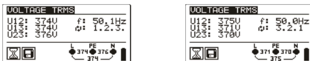
Figura 5.4: Esempi di misurazione della tensione nel sistema trifase
